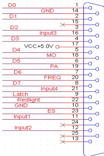
，其中“ES”接 DB37.4, “Input1”接 DB37.15, “Input2”接 DB37.16 。
